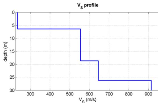
Figura 48 – Profilo tipo di  $V_s$  delle aree con depositi (Zona 2001) o frane. Substrato a 26.1m, MASW 036029L25.
