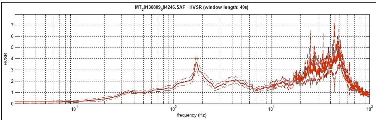
**Figura 31** – Curva H/V rappresentativa dei valori di frequenza minori di 2 Hz. Picco a 1.8 Hz, HVSr 036029P101.
