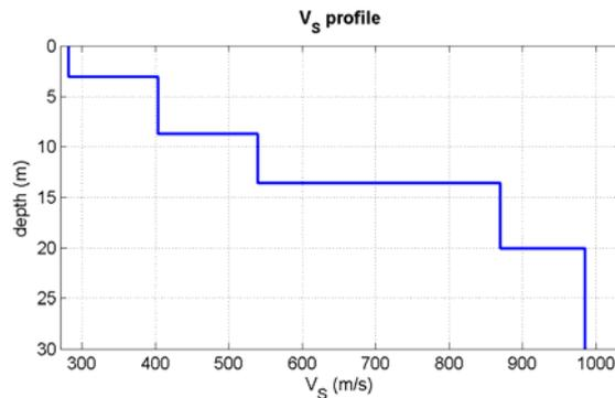
Figura 50 – Profilo tipo di Vs delle aree individuate come zone stabili (1041) Substrato a 13.6, MASW 036029L31.
