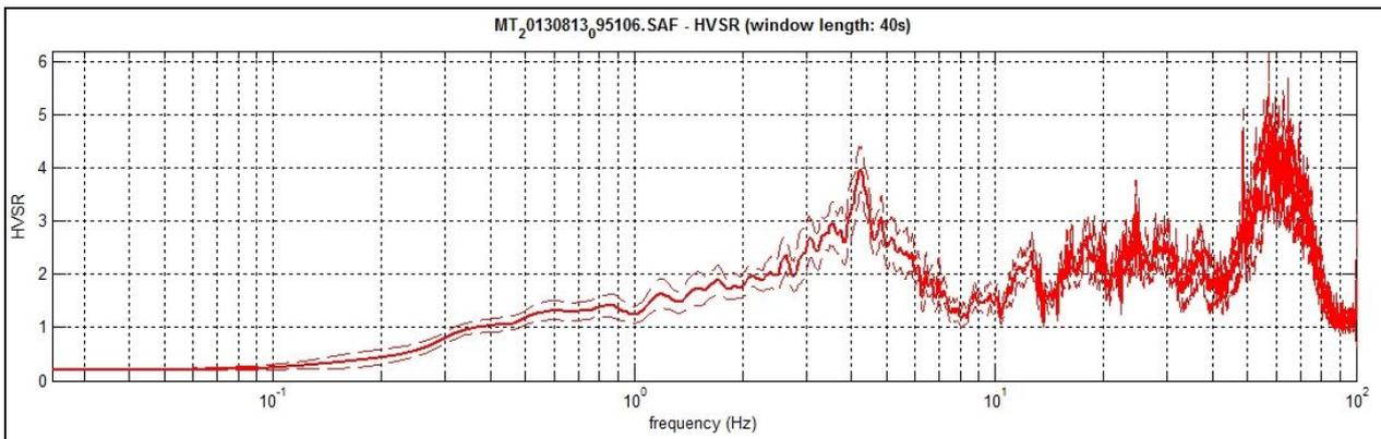
**Figura 32** – Curva H/V rappresentativa dei valori di frequenza compresi tra 2–8 Hz. Picco a 4.3 Hz, HVSr 036029P111.
