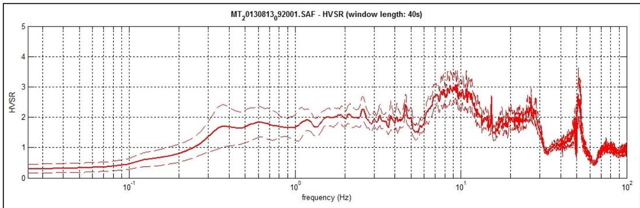
Figura 33 – Curva H/V rappresentativa dei valori di frequenza maggiori di 8 Hz. Picco a 9.3 Hz, HVSR 036029P118.
