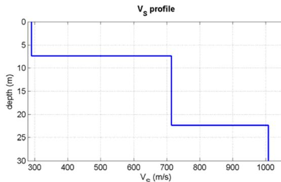
Figura 49 – Profilo tipo di  $V_s$  delle aree con depositi sabbiosi-argillosi (Zona 2002). Substrato a 7.4m, MASW 036029L26.
