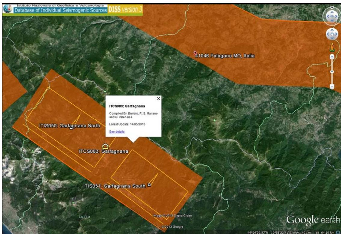
**Figura 8** – Estratto dal database of Individual Seismogenic Sources (DISS) dell'INGV: Sorgente Sismogenetica Composita (ITCS) 083 “Garfagnana” e Sorgenti Sismogenetiche Individuali (ITIS) 050 “Garfagnana Nord” e 051 “Garfagnana Sud”.
